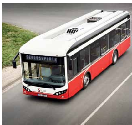
Ein Linienbus mit Batterie auf dem Dach.
